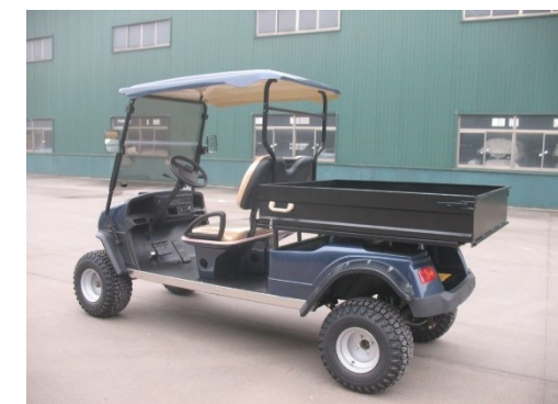
Dimension Benne 1350 x 1100 x 250 Ridelle arrière
